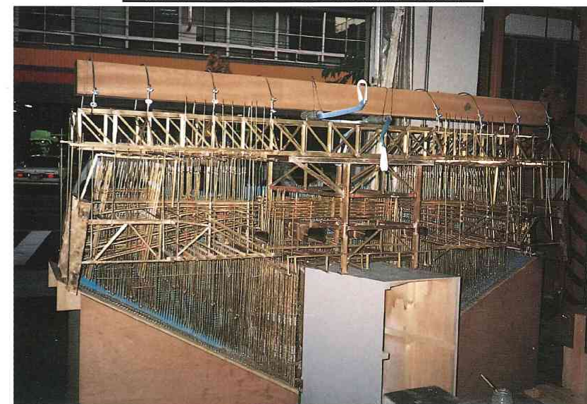
模型による大ブロック架設順序の確認
